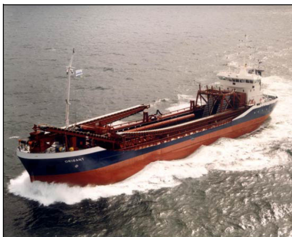
Figura 3.4-1 - Exemplo de Dragagem do Tipo Trailing Suction Hopper
