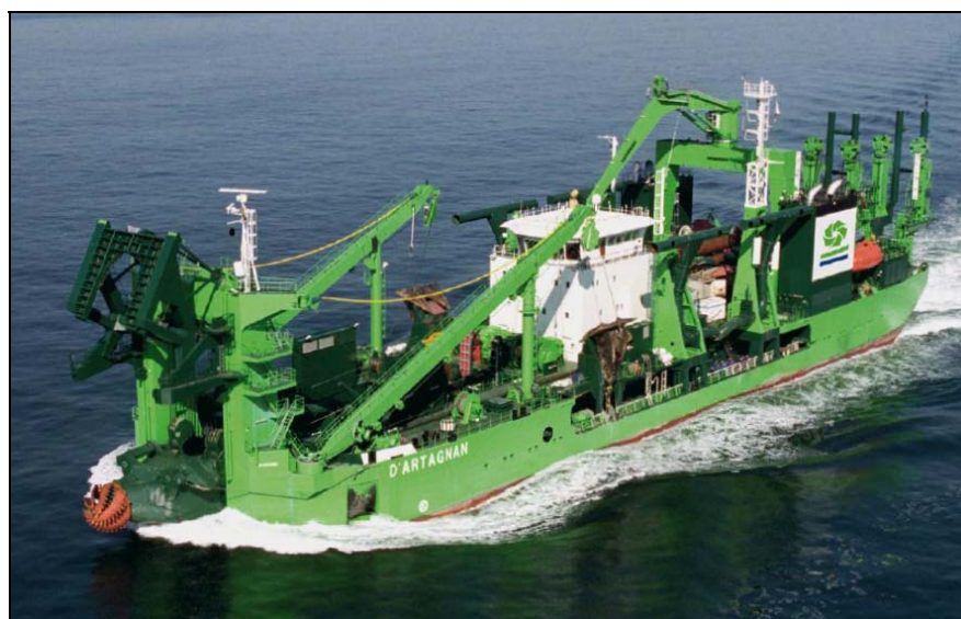
Figura 3.4-3 - Foto de uma draga de sucção e recalque
